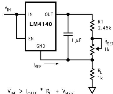
$$V_{IN} > I_{OUT} * R_L + V_{REF}$$
